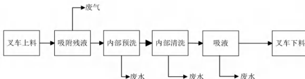
图 4.6-1 吨桶自动清洗处理工艺流程及产污环节图
